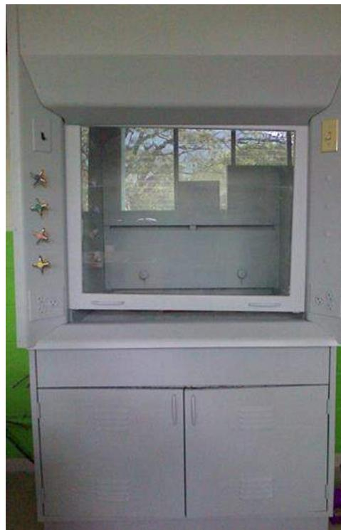
Fotografía No.3 - Cámara de extracción.
