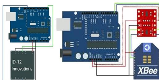
Por otra parte, también se diseñó un dispositivo electrónico interface para el control de circuitos de potencia, construido con accionadores para el control eléctrico, el cual cuenta con un módulo de telecomunicación inalámbrica que funciona bajo el protocolo ZigBee IEEE 802.15.4; éste se enlaza con el
