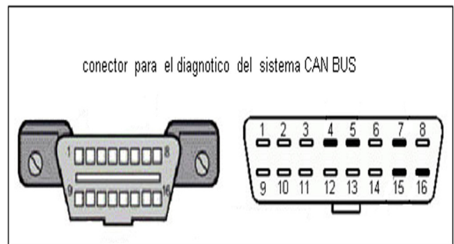
Figura 8. Conector que dispone el fabricante para el diagnóstico electrónico del sistema CAN BUS, entre otros.
