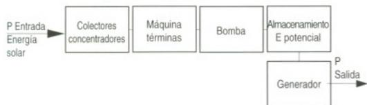
Fig. 8 Estructura básica de una microcentral solar
