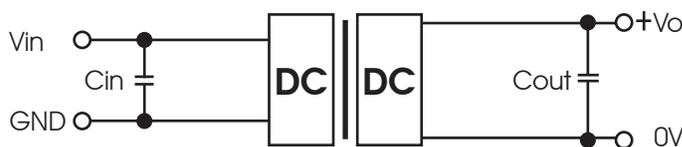
Fig 5. Conexiones típicas para el VBT1-S5-S5-SMT
