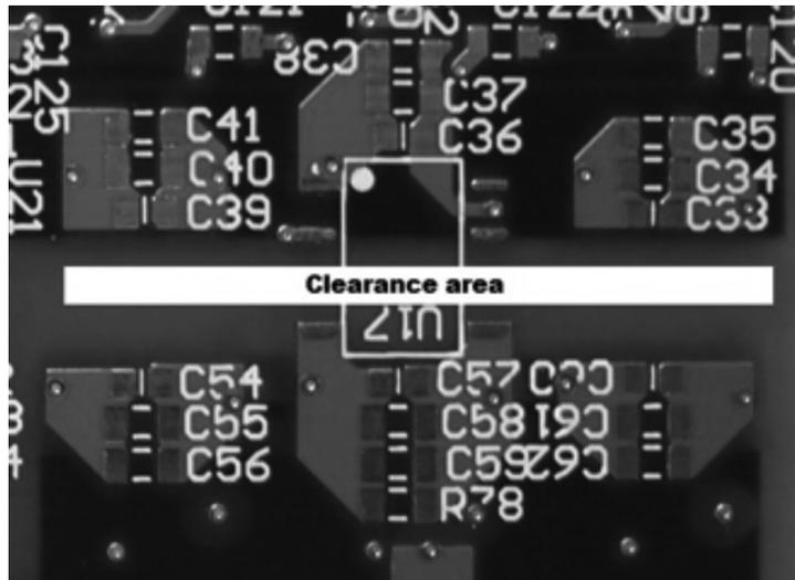
Fig 17. Ubicación de los capacitores de desacoplo.
