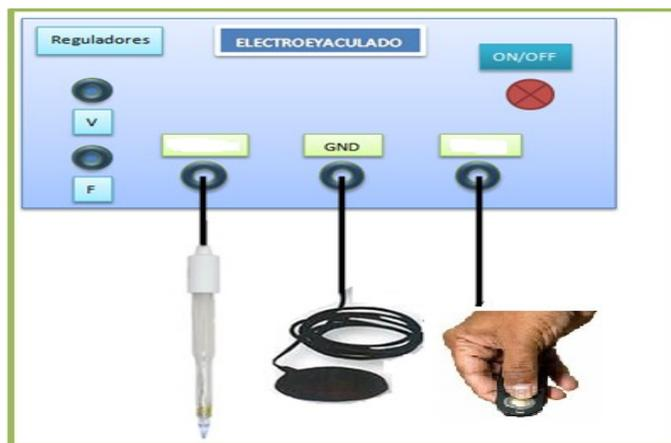
Figura 9. Prototipo de la cara de enfrente del chasis, es decir del panel de control del electro-eyaculador.
