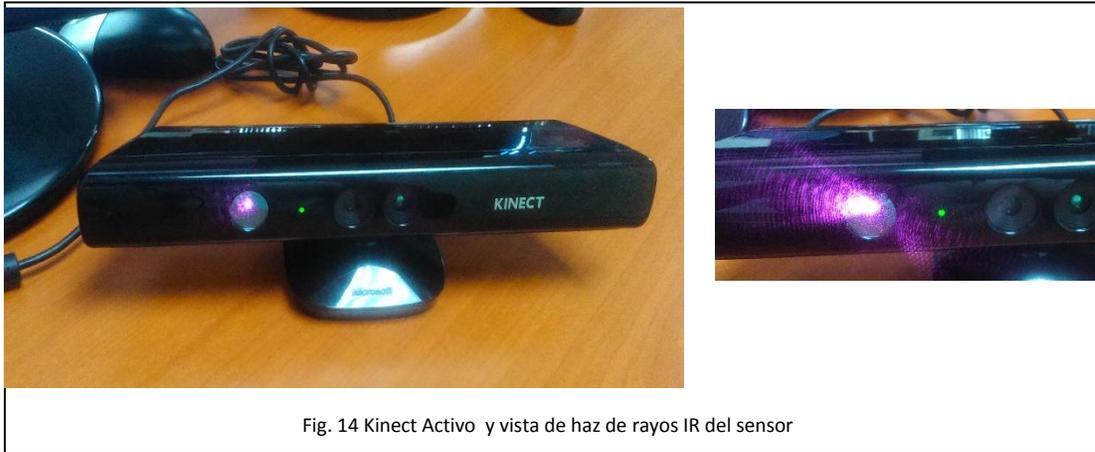
Fig. 14 Kinect Activo y vista de haz de rayos IR del sensor
