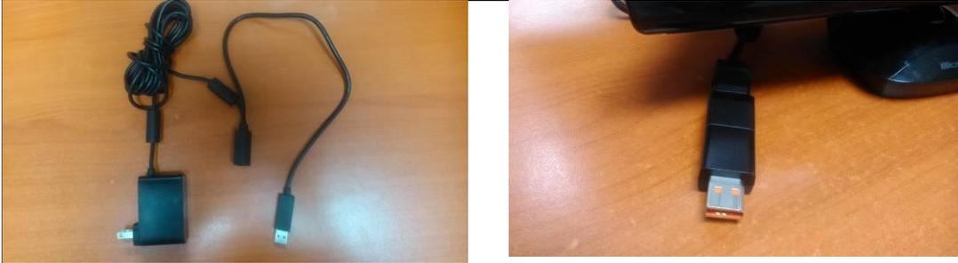
Fig.13 Adaptador de corriente y conector del Kinect
