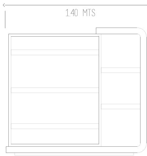
Fig.26: Figura representativa ejemplo vista frontal y lateral de las medidas mínimas del exhibidor tipo back que se propone para estandarizar los puntos de venta.
