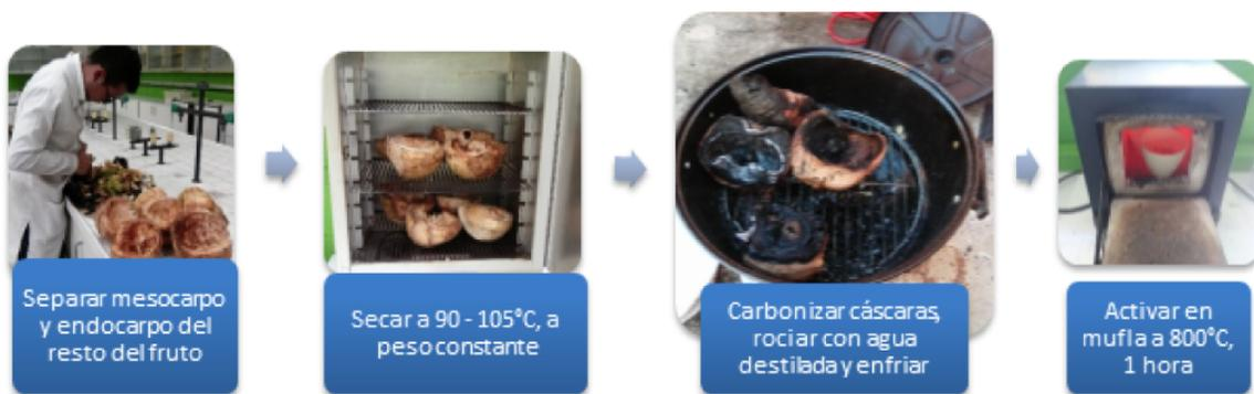
Figura 2. Proceso de elaboración de carbón activado a partir de mesocarpo y endocarpo de coco. Fuente: Elaboración propia
