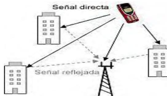
**Figura 2-4. Sistema de localización por "huella multitrayecto".**
