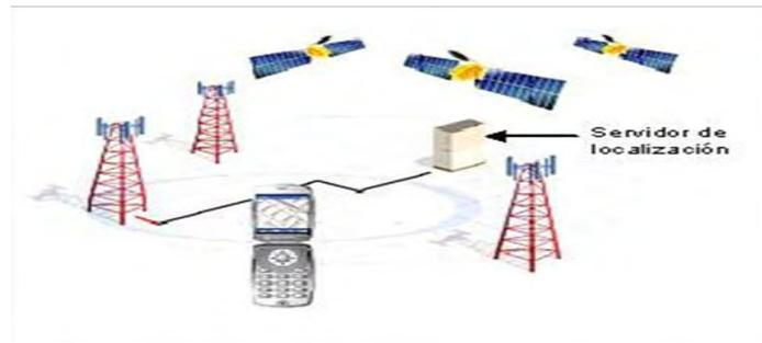
**Figura 2-5. Sistema de localización comercial mediante A-GPS y Cell ID.**
