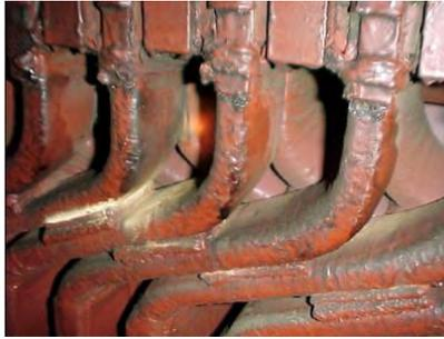
**Figura 2-66. Descargas parciales entre barras por falta de un separador**
