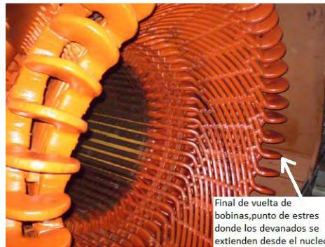
**Figura 2-39. Final de vuelta de las bobinas**
