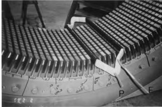
**Figura 2-34. Una bobina siendo insertada en dos ranuras**
