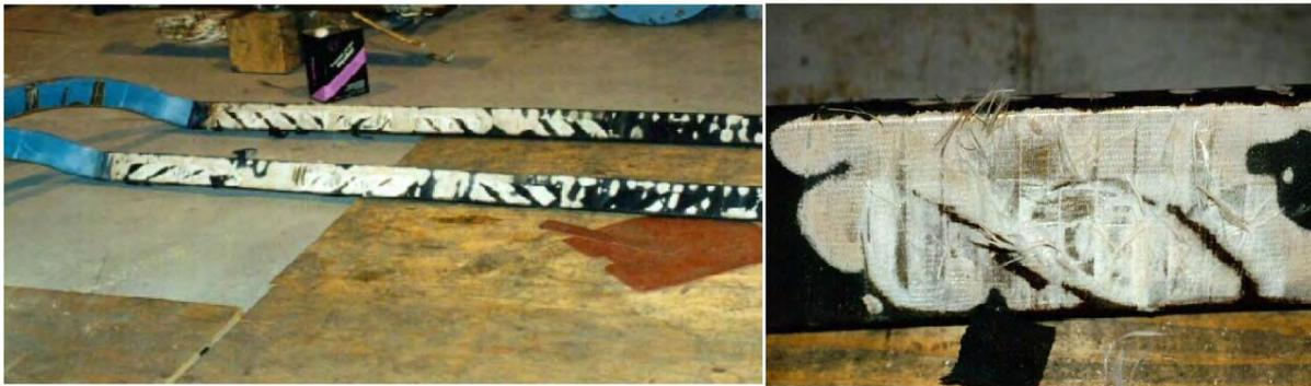
**Figura 2-71. Deterioro de la cubierta semiconductora de la bobina causante de un predominio positivo de pulsos**
