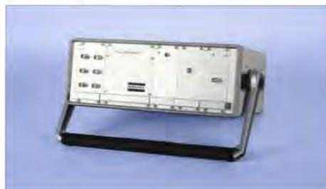
La prueba de Análisis de Descargas Parciales durante la operación de una máquina rotatoria de alta tensión puede detectar serios mecanismos de deterioro del estator tales como descargas en las ranuras, intersticios internos así como cuñas y devanados flojos. Si estos problemas no son detectados, monitoreados y corregidos, pueden ocasionar una falla catastrófica en la máquina.
