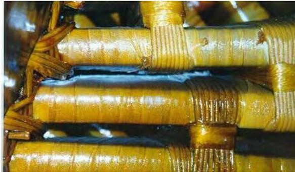
**Figura 2-67. Descargas parciales debido a espacio insuficiente entra barras**
