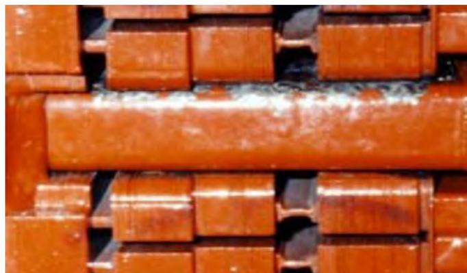
**Figura 2-72. Descarga de ranura en barra estática próxima al final de la ranura (slot)**
