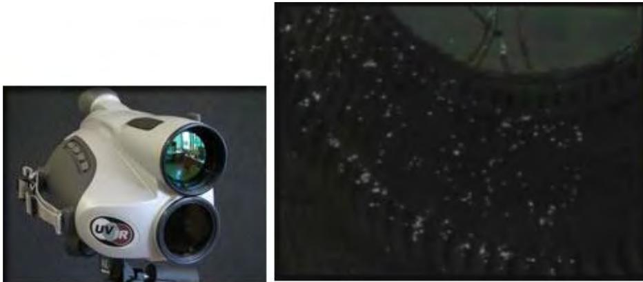
**Figura 2-53. Prueba Black-out a un estator con CoroCam MultiCam UV/IR**
