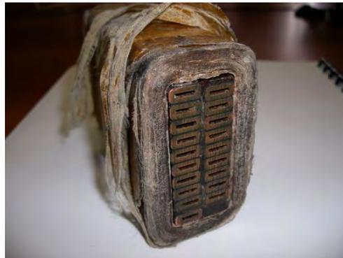
**Figura 2-69. Delaminación interna, predominio negativo de pulsos**
