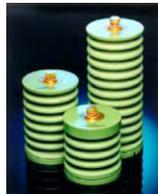
**Figura 2-55. Acopladores capacitivos de 80 pF para 6.9kV, 16kV y 25kV, frecuencias > 40 MHz contruidos en resina epóxica y mica**
