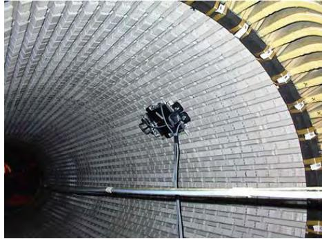
**Figura 2-51. Ensayo de flujo reducido EL-CID mediante el uso de vehículo robotizado**
