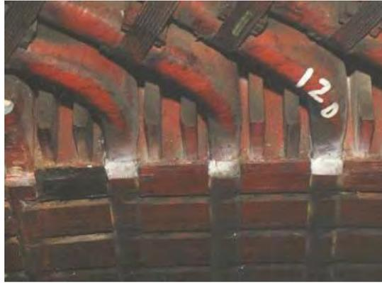
**Figura 2-73. Descargas en las salidas de las ranura**
