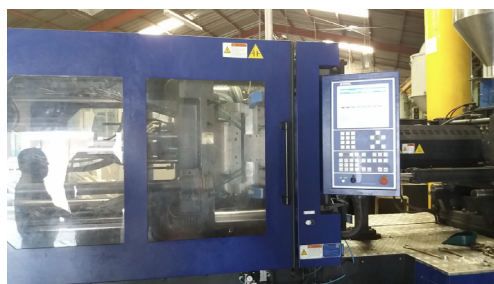
Figura 7. Máquina inyectora con el molde montado en su interior.
