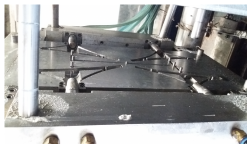
Figura 6. Molde de inyección montado en la máquina y produciendo.
