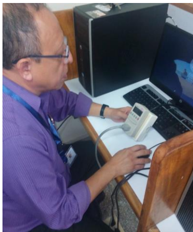
Medición de potencia en computadoras eficientes
