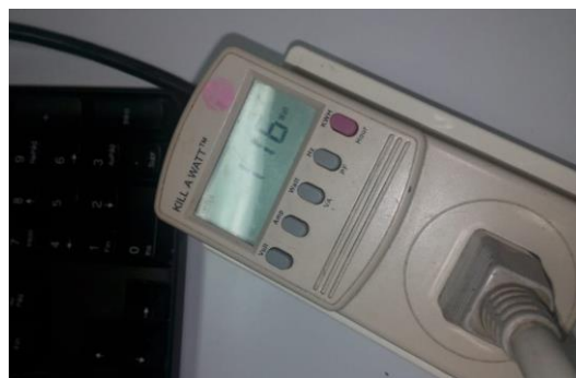
Medición de potencia en computadoras de alto consumo
