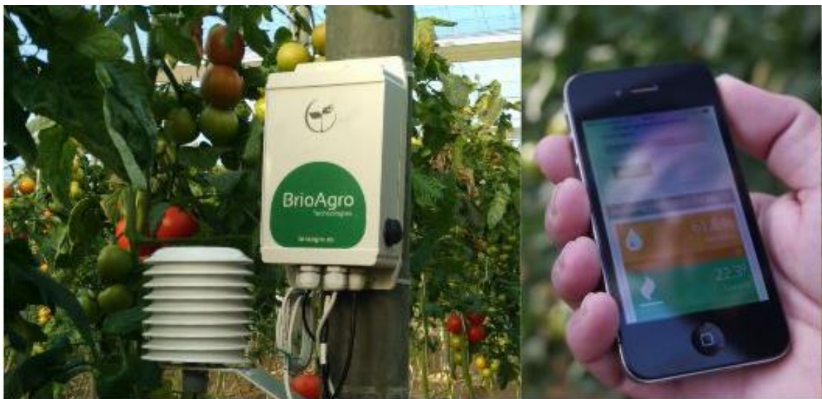
Imagen 6. BrioAgro ViTA 12 – Dispositivo de campo conectado a sensores para invernaderos.
