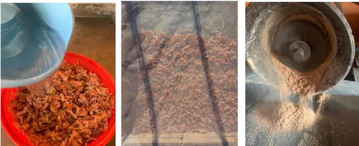
Figura 10. Obtención de harina de caparazón Etapa de lavado, secado y molienda de caparazón Fuente: Fotografía tomada por el grupo de trabajo
