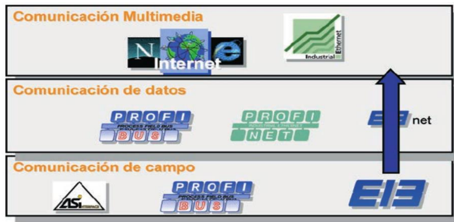
Figura10. Redes de comunicación industrial Siemens.
