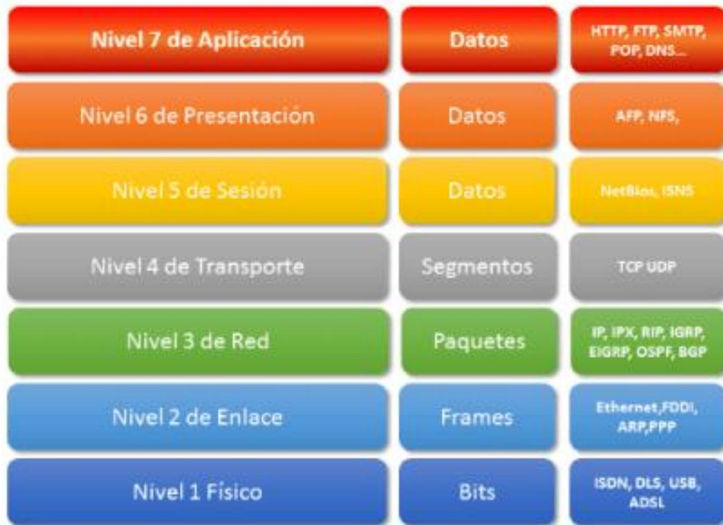
Fig. 2: Pila OSI.
