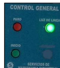
línea” de un color rojo a verde; dando lugar a que se inicie el proceso automático de halado de la bobina y sellado de su eje vertical y horizontal.
