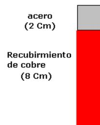
Figura 2. Forma de preparar el trozo cortado de la barra, para soldar a la solera de fundación
