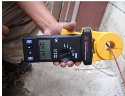
Fotografía 3. Lectura del Telurómetro Digital  $R = 0.419 \Omega$
