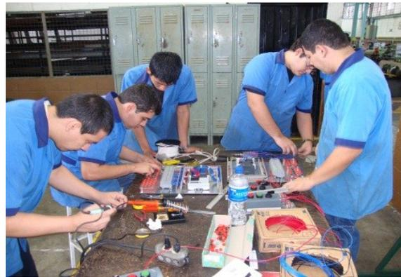
Fotografía 5. Instructores y estudiantes ensamblando componentes electrónicos del entrenador: PLC, sensores, relés, válvulas, cilindros, botonerías, luces pilotos, entre otros.
