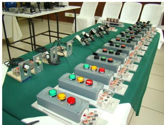
Fotografía 3. Luces piloto, sensores y botoneras.
