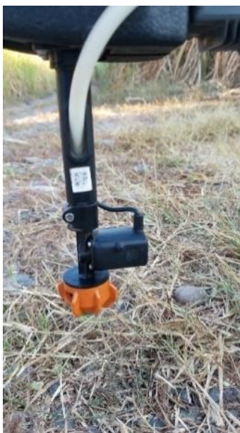
Ilustración 15. Boquilla XR11001 de drone de riego.
