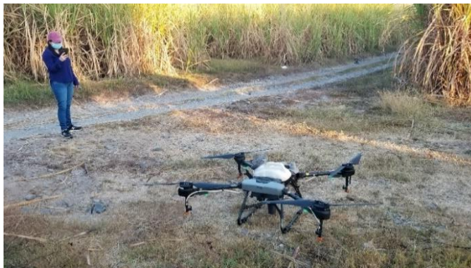
Ilustración 14. Drone utilizado para riego con capacidad de 10 L de producto.
