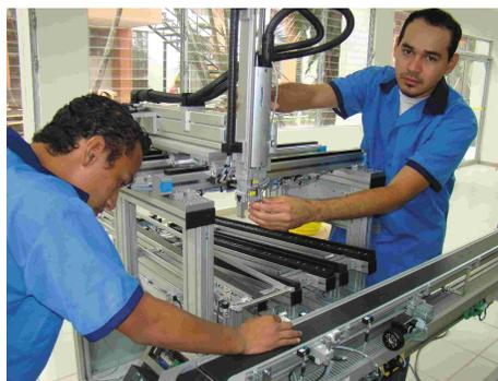
Figura 1: Robot para apilar cajas ITCA-FEPADE
