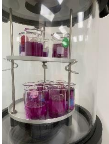
Figura 37. Liofilización de pulpa de pitahaya.
