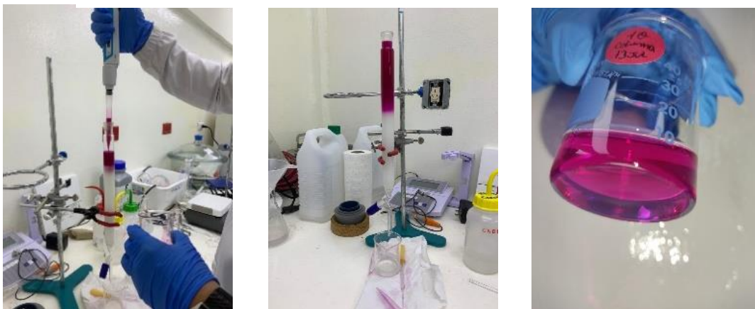
Figura 34. Purificación por cromatografía en columna.
