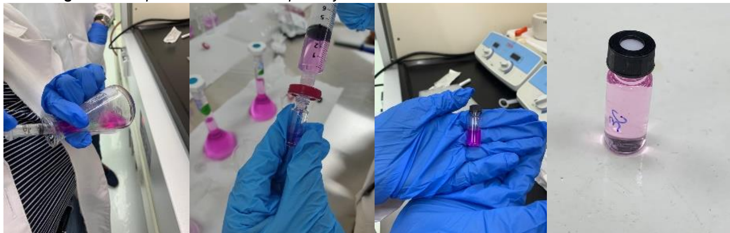
Figura 36. Preparación de muestras para inyección en HPLC.
