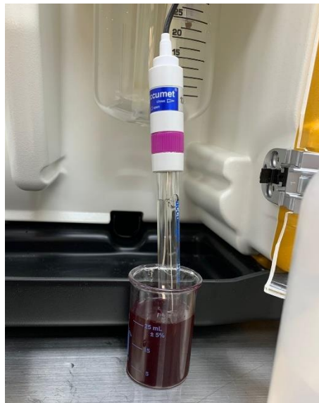
Figura 29. Medición de pH.
