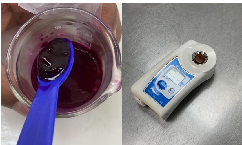
Figura 30. Medición de grados brix.
