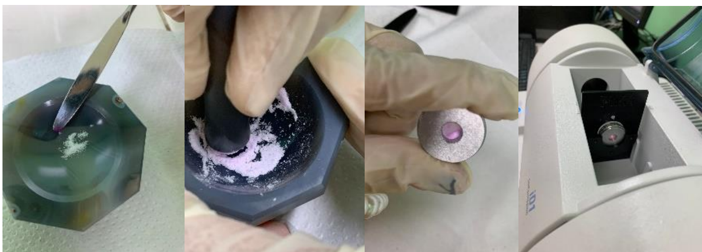
Figura 40. Preparación de muestras para análisis FTIR.
