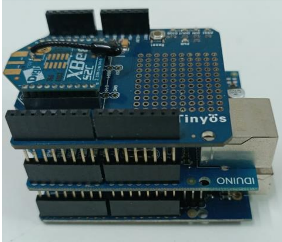
Fig. 14. Pasarela de ZigBee a MODBUS.
