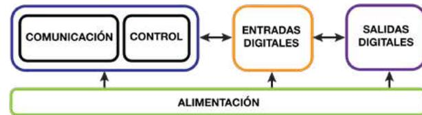
Fig. 3. Diagrama de bloques de la RTU.
