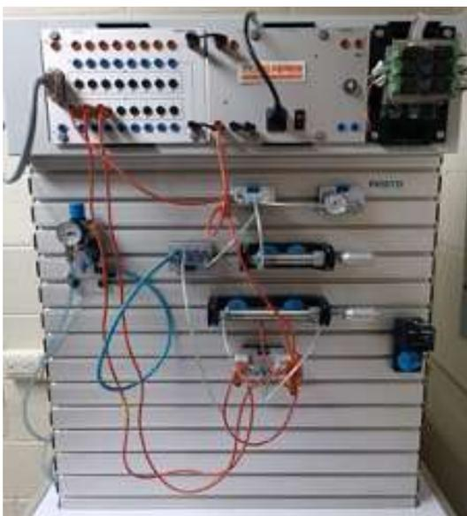
Fig. 11. Vista del módulo con el montaje de componentes neumáticos y electroneumáticos.
