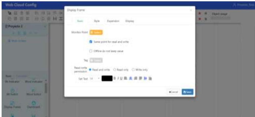
FIGURA 78: CONFIGURACIÓN BÁSICA DE VARIABLE ANALÓGICA PARA ELEMENTO VISUAL.
