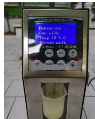
Fig. 2. Analizador de leche modelo Ultrasonic Milk Analyzer
