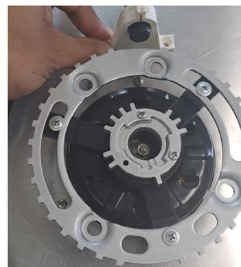
Fig 2. Base de porta sensores y reductor diseñado.
