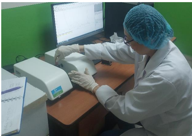
Identificación y cuantificación de antocianinas por espectrofotometría UV.
