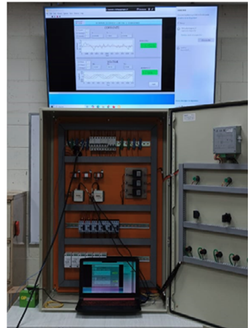
Fig. 7: Panel de Control Automático y pantalla LabVIEW.
