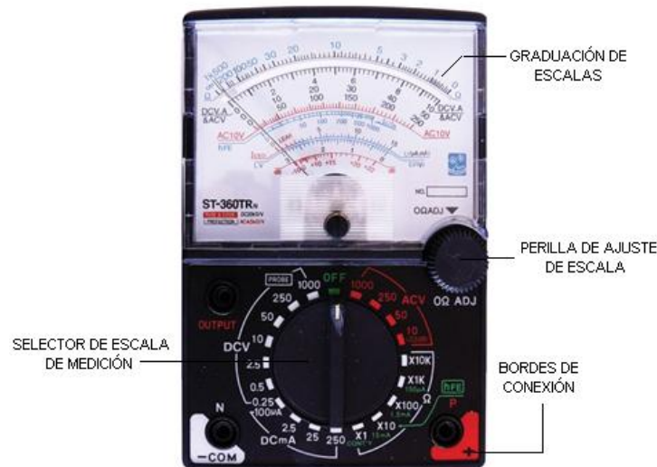
FIGURA 2 (MULTIMETRO O TESTER ANALÓGICO)
