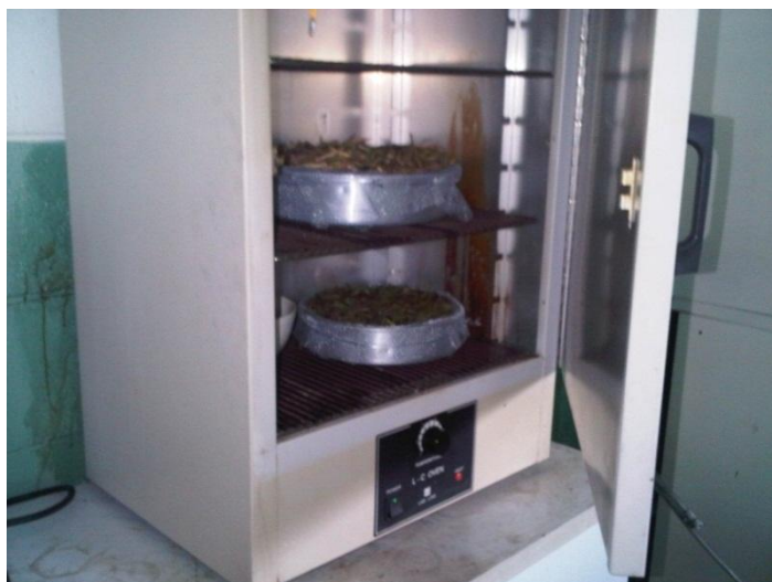
Figura 3. Los pitos colocados en la estufa sobre los recipientes que se armaron.
