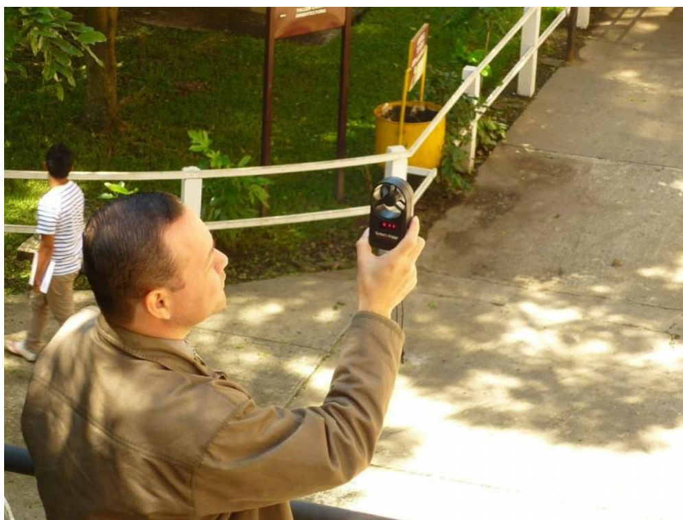
Fig. 1. Medición de viento en gradas de emergencia de edificio L.
