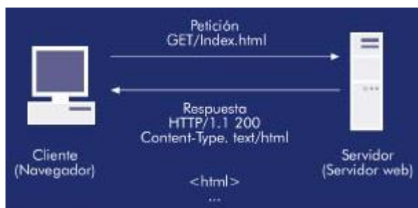
Fig. 4.3. Funcionamiento de Peticiones y Respuestas Usando Protocolo HTTP
