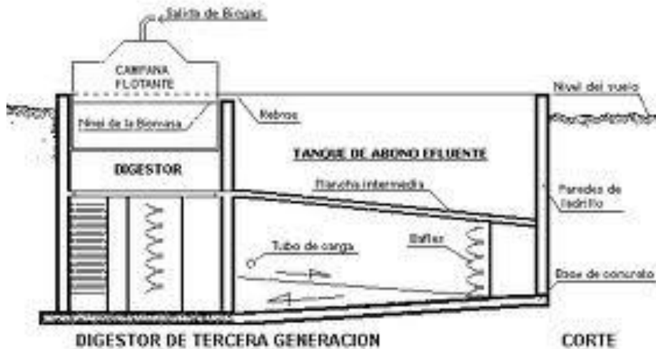
Figura # 8, digestor de alta velocidad, biodigestoresmjhr.blogspot.com
