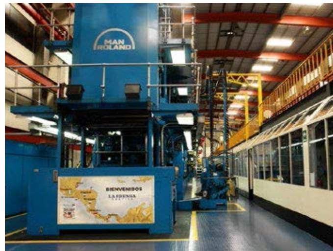
Imagen 10 Máquinaria actual, Man Roland. Ejecuta procesos de impresión, compaginación y plegado del periódico. Ubicada en las instalaciones de La Prensa Gráfica.
