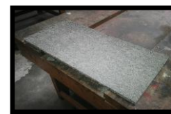
Características de algunos elementos elaborados a partir de mortero con plástico reciclado
