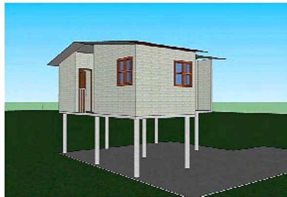
Estructura de sistema de palafitos con altura de 2.10, para el mejor aprovechamiento del espacio como corredor
