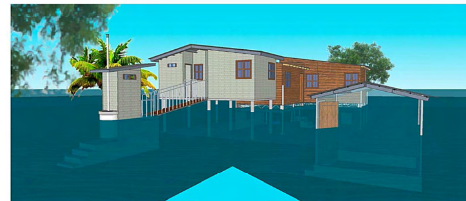
Funcionamiento de estructuras palafitica y anfibio durante el incremento del nivel de agua producido por eventos extremos, alcanzando niveles de 2 metros.
