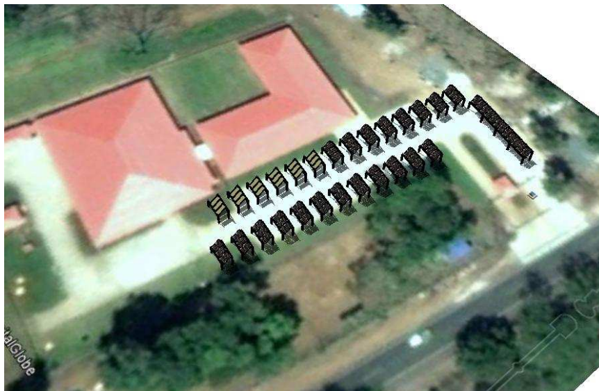
Imagen 11: Esquematización del emplazamiento Fotovoltaico y térmico
