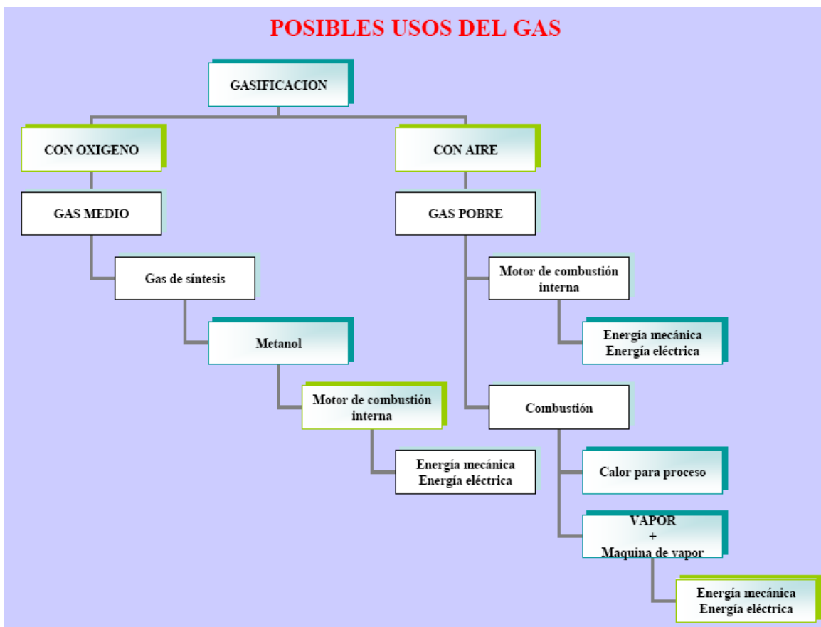
Fig. 3.24 Utilidad del uso del gas en el proceso de gasificación de la biomasa. (Fuente: Documento “Gasificación de Biomasa”, Dr. Ing. René Lesme Jaen, Universidad de Oriente, Cuba)
