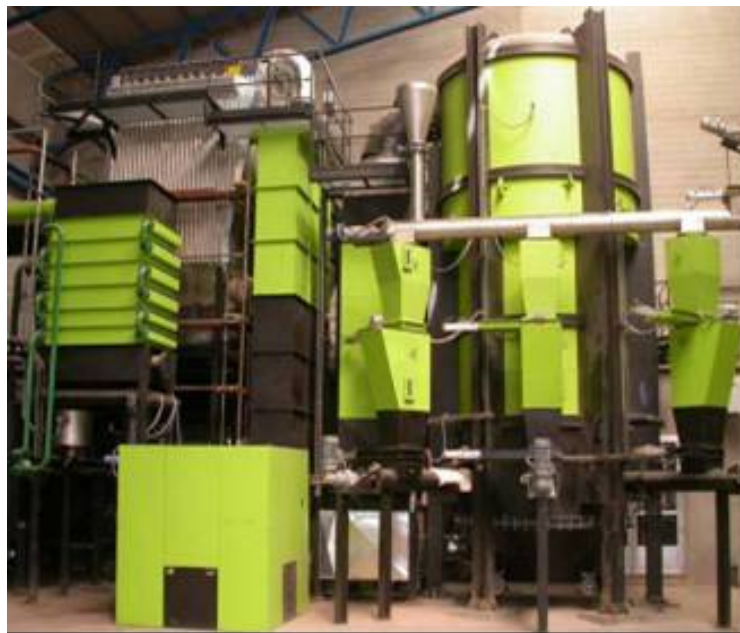
Fig. 3.40. Gasificador de Biomasa para Motor-Generador Tipo "B". (Fuente: Documento: " Planta de Cogeneración con Gasificación integrada de Biomasa (IBGPP) ", www.eqtec.es ).
