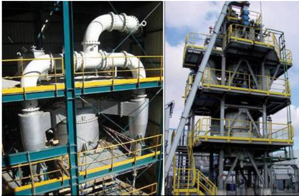
Fig. 3.39. Esquema de Gasificador de Biomasa para Motor-Generador Tipo "A". (Fuente: Documento: "Biomasa y Gasificación" 2007, IDAE, www.idae.es ).
