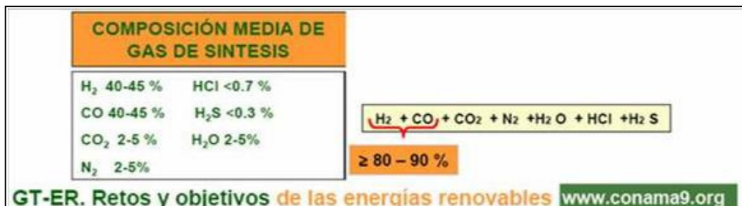
Fig. 3.92. Composición estimada del gas de síntesis del gasificador de plasma de biomasa.
