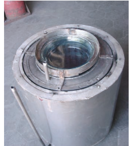
Figura 2. Fotogenerador de vapor en su cápsula aislante térmica
