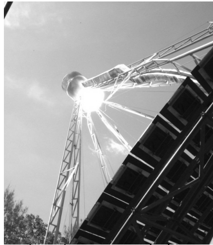
Figura 14. Fotogenerador de vapor colocado en el foco de un concentrador solar de dos ejes diseñado y construido en El Salvador bajo auspicios financieros del Fondo para la Iniciativa de las Américas El Salvador.
