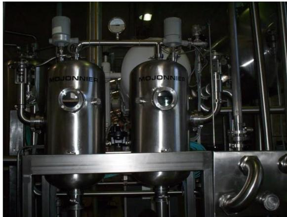
**Figura 31. CARBONATADOR Y ELEMENTOS QUE LO CONFORMAN**
