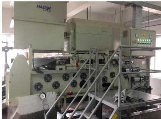
**Figura 29. FILTRO PRENSA DE BANDA HTB 1500 HAIBAR**
