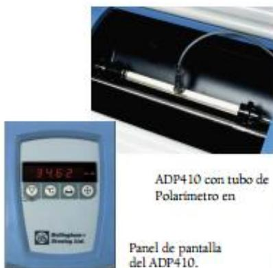
ADP410 con tubo de Polarímetro en
