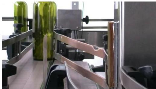
**Figura 38. RECHAZADOR DE BOTELLAS NEUMÁTICO DE ALTA VELOCIDAD**
