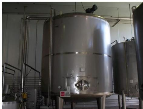
**Figura 30. TANQUE DE JARABE TERMINADO**
