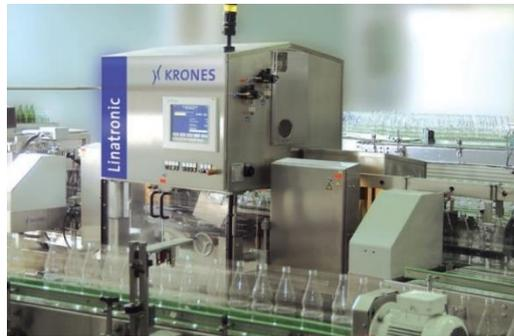
**Figura 36. INSPECCIONADORA DE BOTELLAS VACIAS LINATRONIC 735**
