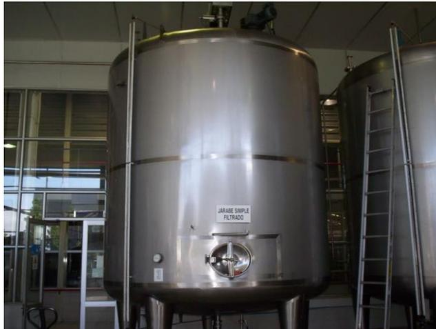
**Figura 27. TANQUE DE MEZCLA DE JARABE SIMPLE.**
