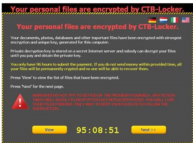
Fig. 3. Pantalla que notifica a la víctima que toda su información ha sido encryptada, que debe pagar el monto establecido en el tiempo determinado por el atacante
