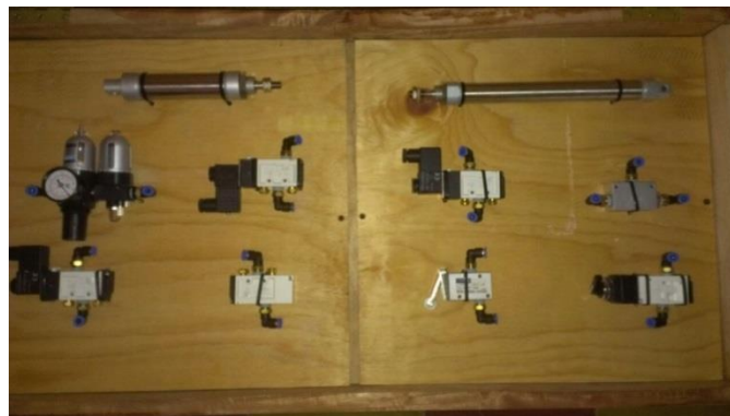
FIGURA 23. ASPECTO FÍSICO DE ELECTROVÁLVULAS
