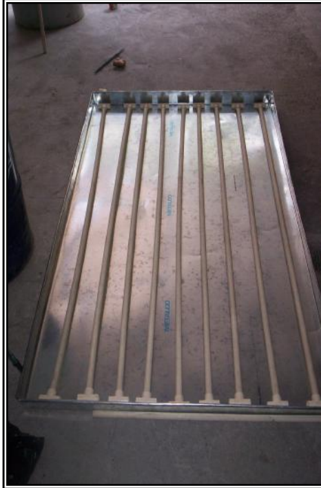
Tubos de CPVC instalados provisionalmente en el colector.
