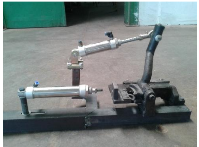
Fig.10. Máquina de la Asociación APRAINORES intervenida con sistema neumático.
