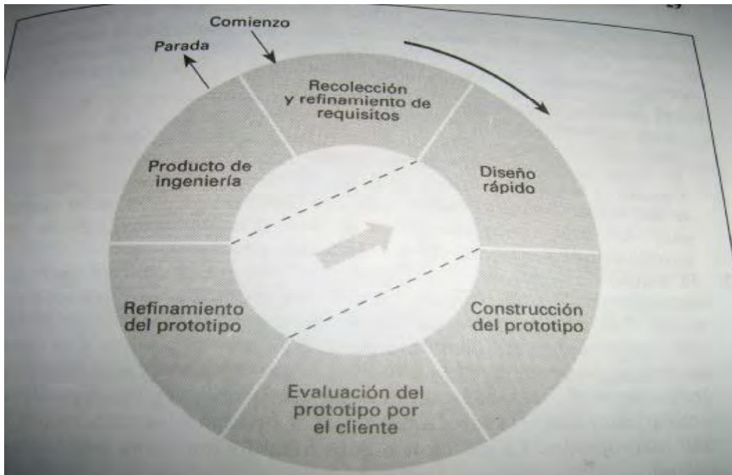
Figura 2.4. Fases del ciclo de vida del sistema. Secuencia de sucesos del modelo de prototipos [Autor: Kendall & Kendall, Fuente: Análisis y Diseño de Sistemas, tercera edición].
