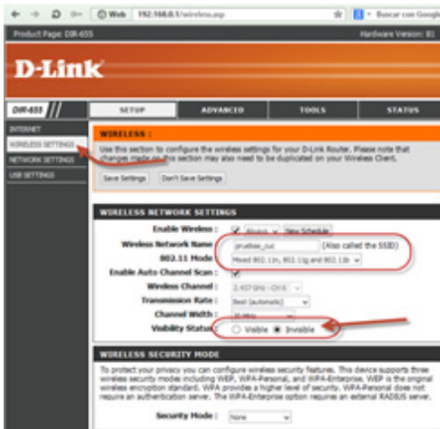
Figura n.º 3 Pantalla de ejemplo para configuración de las opciones inalámbricas
