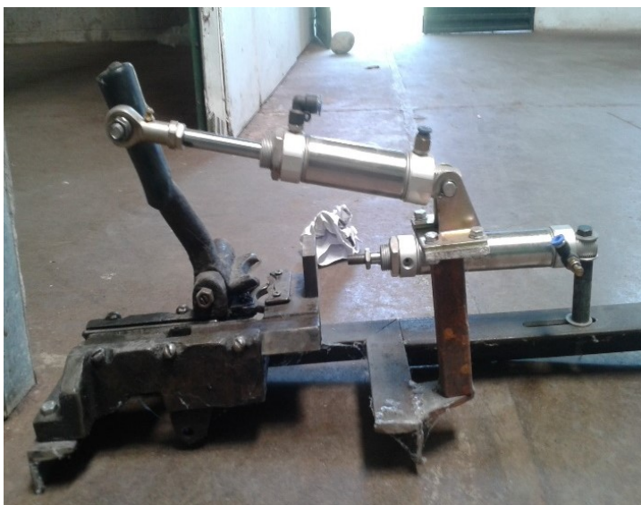
Sistema neumático adaptado a máquina existente.
